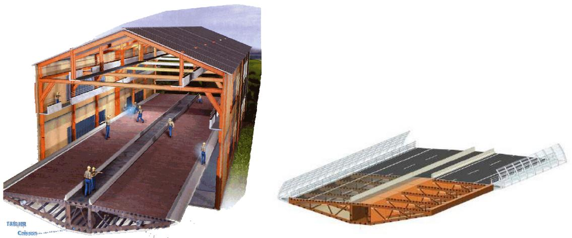
Figure IX.10 : Structure métallique en forme de double aile d'avion du tablier du Viaduc de Millau.
