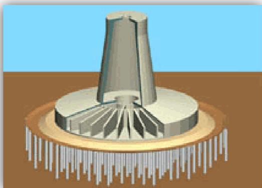
Fig. IX.3 : Fondations des piles du pont de Rion-Antirion - Grèce
