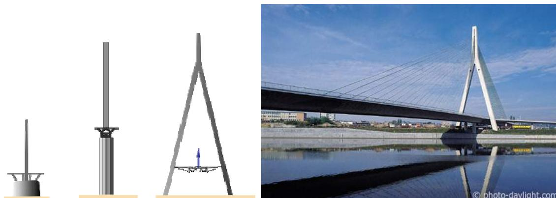
Figure IX.7: Forme des pylônes pour une simple nappe de haubans, comme le Pont de Wandre, Liège, Belgique.
